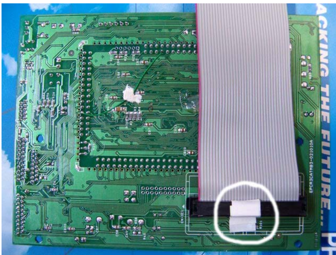
Пломба између кабла фискалне меморије и главне плоче
